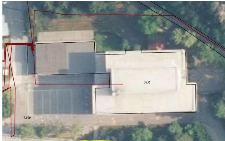
Prikaz infrastrukture električnega omrežja na lokaciji stavbe (vir: GIS)
